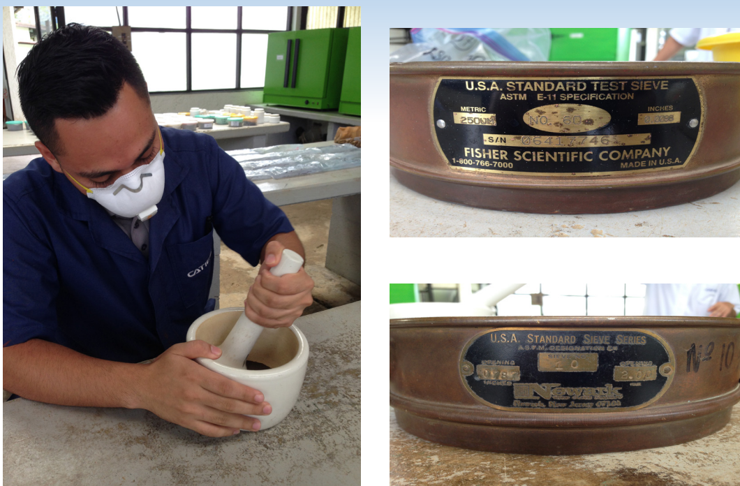
Figura 21. Morterizado de muestras de suelos de manglar y tamices estándar de dimensión ASTM 10 (2 mm) y ASTM 60 (0,250 mm) utilizados para homogenizar las muestras. Fotografías: Miguel Cifuentes
