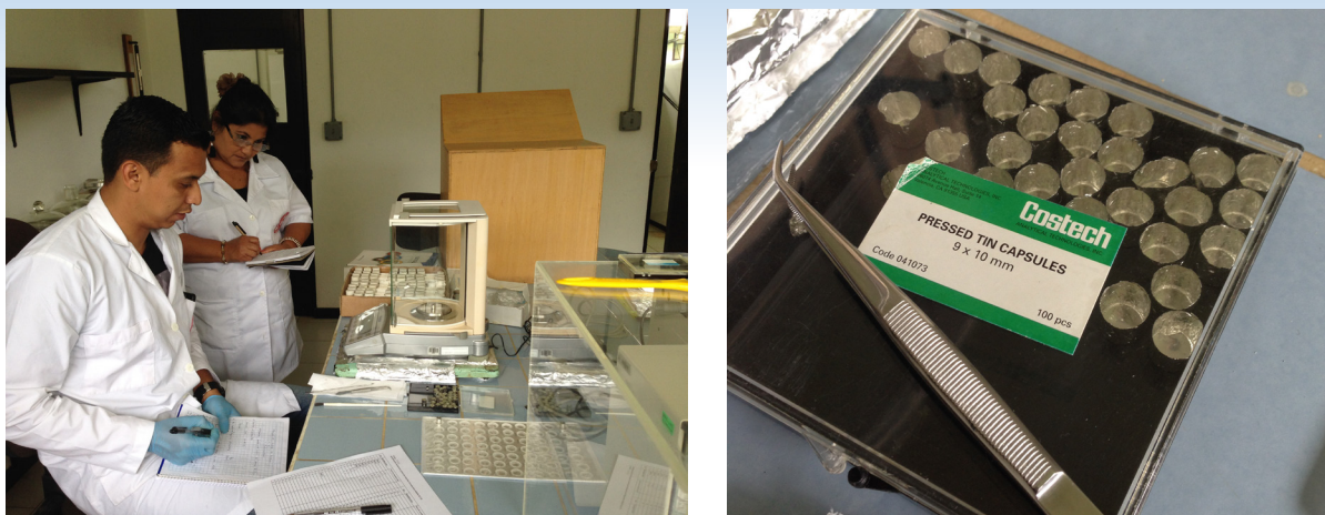
Figura 22. Pesado de muestras de suelo de manglar con balanza analítica de alta precisión (izquierda). Las muestras se colocan herméticamente dentro de pequeñas cápsulas de estaño (derecha) durante el pesado y en preparación para el posterior análisis. Fotografías: Miguel Cifuentes
