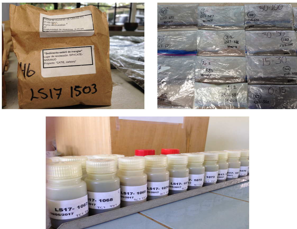
Figura 20. Ejemplos de etiquetas de muestras de suelo de manglares en el momento en el que se reciben en el laboratorio (arriba) y una vez ingresadas a la cadena de custodia del mismo (abajo). Fotografías: Miguel Cifuentes.
