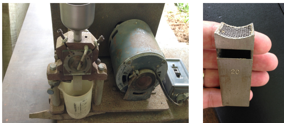
Figura 23. Molino analítico utilizado para moler muestras de tejido vegetal (izquierda). Ejemplo de un tamiz estándar para uso en el molino de tejido vegetal (derecha). Fotografías: Miguel Cifuentes.
